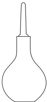
Hohlkörper aus cadmiumfreiem Weich-PVC mit aufgesetztem Klistierrohr. Auskochbar, nicht jedoch Sterilisation im Autoklaven. Das Klistierrohr abnehmen und getrennt sterilisieren.
